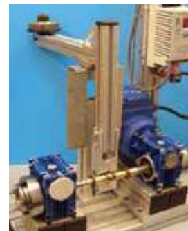
Рисунок 3 Установка для испытаний на износ
